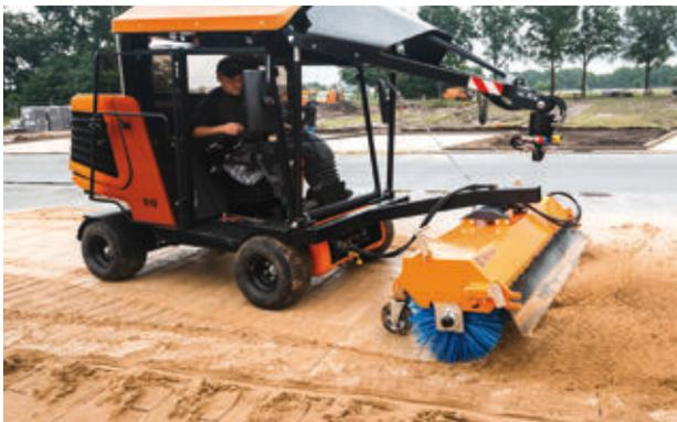
Bild 64: Pflaster-Einkehrmaschine
