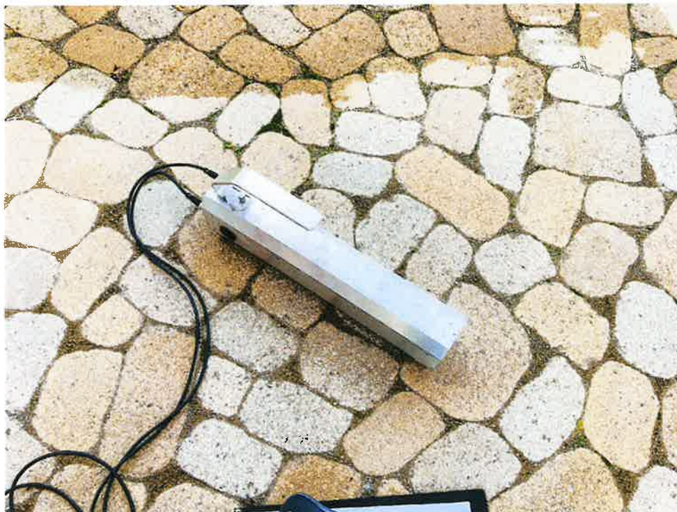
Bild 1. Die Pflasterfläche aus Beton ARENA, wilder Verband, mit dem aufgebauten Laser System SCHULZ-SYSPRO zwecks der Messung der Profilhöhe, hier Aufnahme am 30.03.2026.
