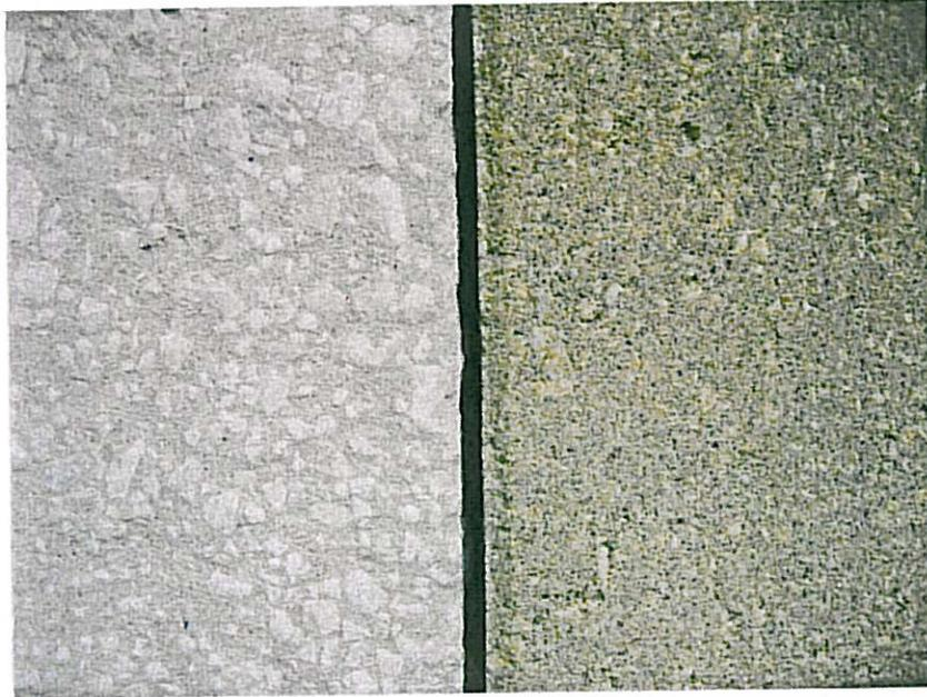
Bereits nach 35 Minuten war die Oberfläche der oberflächenkristallisierten Pflastersteine abgetrocknet. Der gleiche Zustand wurde bei den Pflastersteinen mit herkömmlicher Vorsatzschicht nach 6,5 Stunden erreicht.
