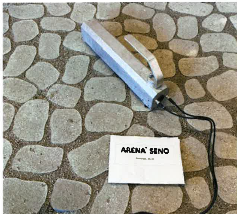
Bild 1. Die Pflasterfläche aus Beton ARENA SENO, mit dem aufgebauten Laser System SCHULZ-SYSPRO zwecks der Messung der Profilhöhe, hier Aufnahme am 30.03.2026.
