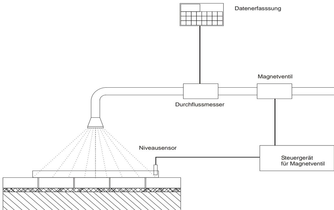
Die Versickerungsintensität wurde über die Änderung des Zuflusses am Zulauf mit Hilfe eines elektronischen Durchflussmessers registriert. Die Infiltrationsrate als versickerte Menge pro Zeit ergibt sich aus der Regelung des Zuflusses in Abhängigkeit zur Veränderung der Wasserfilmdicke auf der Untersuchungsfläche.
