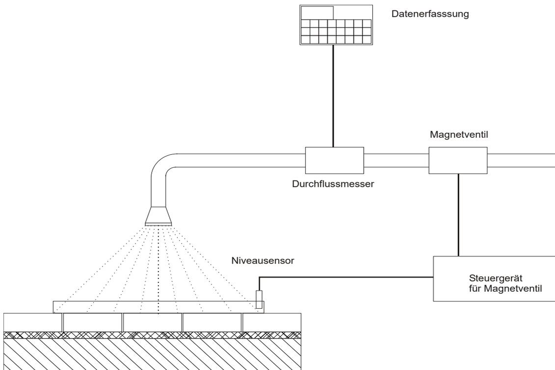
Die Versickerungsintensität wurde über die Änderung des Zuflusses am Zulauf mit Hilfe eines elektronischen Durchflussmesseres registriert. Die Infiltrationsrate als versickerte Menge pro Zeit ergibt sich aus der Regelung des Zuflusses in Abhängigkeit zur Veränderung der Wasserfilmdicke auf der Untersuchungsfläche.
