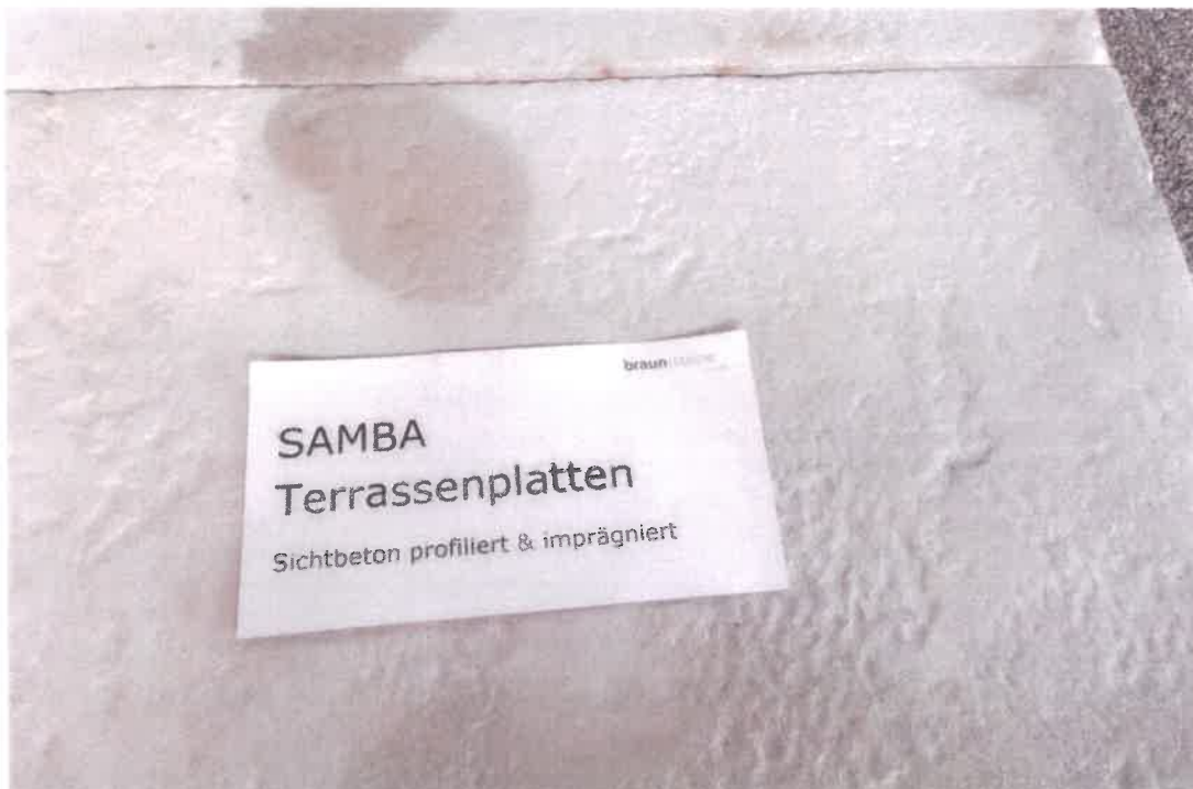
Bild 1. Die zu prüfende Oberfläche, SAMBA Sichtbeton, profiliert + hydrophobiert, im aufgebauten Zustand.
