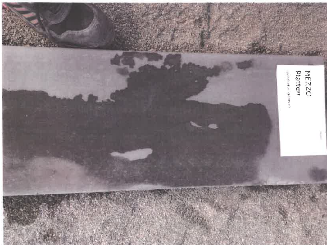
Bild 1. Die zu prüfende Oberfläche, MEXXO, Sichtbeton, gepixelt + hydrophobiert , im aufgebauten Zustand.
